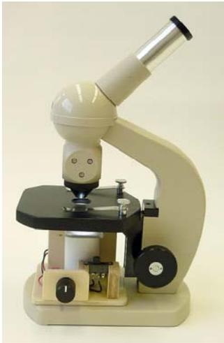
採光のことを考えずに、いつでもどこでもすぐに、顕微鏡観察が行えるLED照明装置は大変便利である。最近の顕微鏡は照明にLEDを採用している。従前の反射鏡付顕微鏡にLED装置を付けられないかと考え、工作が簡単でしかも費用が安いものを工夫し自作した。
